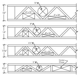
MECHANICAL SERVICE CLEARANCE **DETAIL NO. 17**
